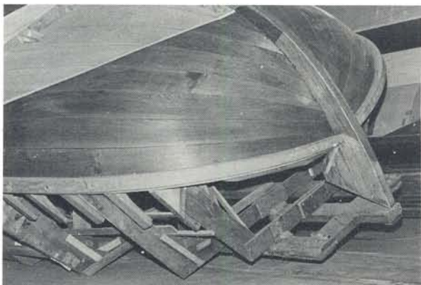
Afb. 24 De boeier wordt gekeerd, nadat zij 'op de kop' is gebouwd. Foto: G. van Slooten
