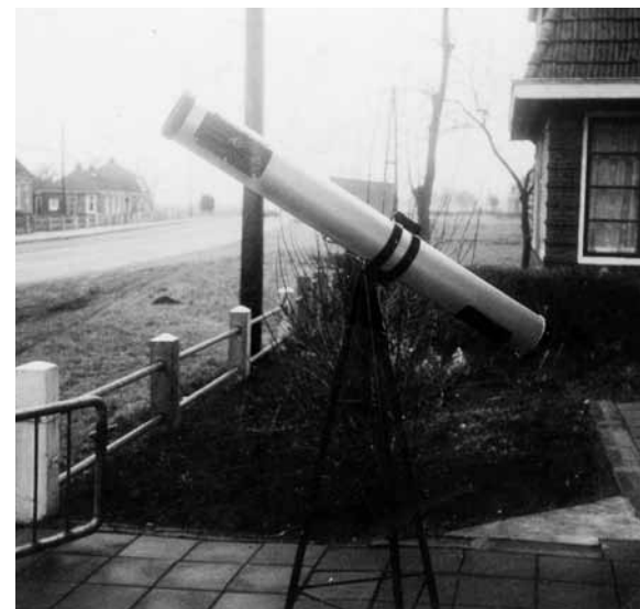
Spiegelkijker gemaakt door Klaas Jansma met een doorsnede van 12,5 centimeter, nog te bezichtigen in Sterrenwacht Burgum.
