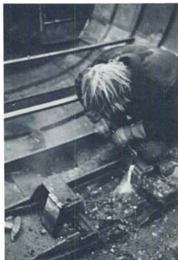
Foto 1: Het afbranden van de polyesterlagen. Foto 2: Over een rond schip gesproken. Foto 3: Hielke Wildschut bezig de drie motorsteunen weg te branden. Foto 4: Het afhangen van het nieuwe roer. Foto 5: Waar eerst de bun zat zijn nu spanten aangebracht. Foto 6: Het voordek en de mastkoker zijn weggesloopt. Foto 7: Hier is duidelijk te zien dat het volume van het voorschip groter is dan dat van het achterschip.
